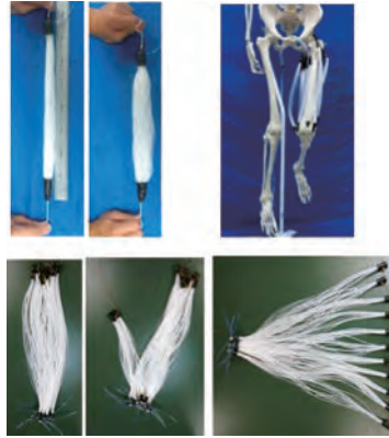
人工筋用ソフトアクチュエータ Soft actuator for artificial muscle
