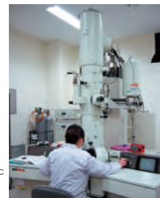
高分解能電子顕微鏡による 金属材料の結晶構造観察 High-resolution electron microscopic observation of crystal structure of metallic materials
