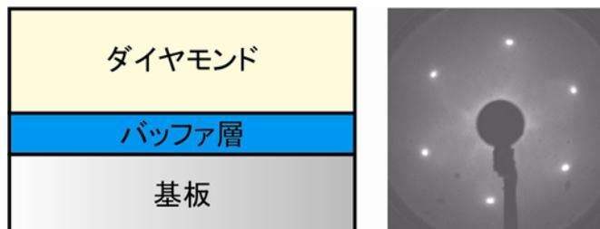
図 1. ダイヤモンドのヘテロエピタキシャル成長系の模式図とバッファ層からの低速電子線回折の例。
