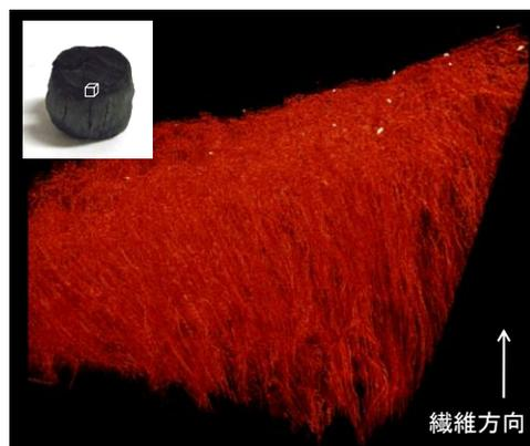
図 3 バイオマス炭化物内部の 3次元構造(X 線 CT)
