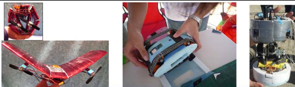
図1 東工大チームが開発した模擬人工衛星 Cansat の例。 (左から、ロケットからの放出後に展開する有翼機(2007年)/惑星探査ローバーのように砂漠で目的地に向かうローバー型機体(2009年)/上空で2機に分離して親機が子機を撮影する機体(2009年))
