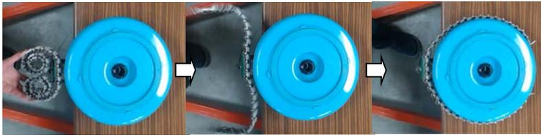
Fig.4 円筒（ロケット上段を模擬）把持実験
