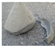
図-2 円錐型試験体破壊形態
