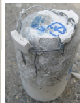
図-6 補強試験体破壊形態
