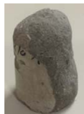
図-5 繰り返し加圧後の楕円状破壊面
