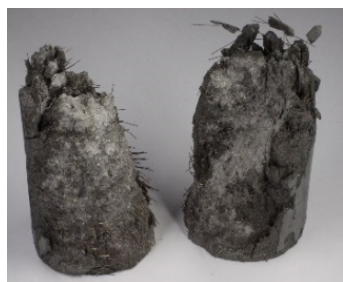
図2 圧縮破壊後の供試体の一例
